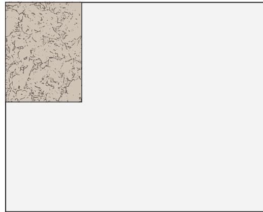
Påfør monteringslim nøye rundt hele kanten på flisen med maks 10 mm avstand fra kanten. Fortsett med limen i slangeform på resten av flisen med maks 5 cm avstand i midten.
