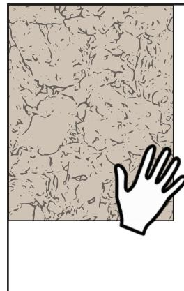
Avkapp fra siste flis på en høyde benyttes på neste høyde (så sant det er minimum 15-20 cm avkappsbit), slik at mønsteret blir verbandt. Da blir det en sømløs vegg og minst mulig svinn.
